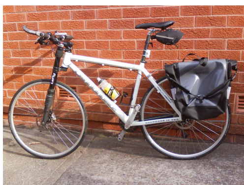
Due versatili MTB 26'' , adattate all'uso cicloturistico con pneumatici stradali, borse e portapacchi posteriore
