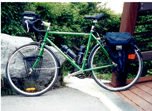
Due tipiche Touring bikes con manubrio da corsa, portapacchi anteriori e posteriori e ruote da 28''
